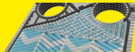
Эксклюзивный рисунок рифления позволяет потоку равномерно распределяться по поверхности пластины, повышая эффективность теплообмена, в то же время снижая скорость загрязнения пластин. Как следствие, для достижения заданной нагрузки теплообменнику необходимо меньшее количество пластин, что снижает его стоимость.
