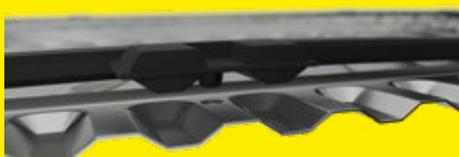
Уплотнения Кельвион идеально сочетаются с пластинами для обеспечения безотказной работы. Отверстия с развальцованными краями обеспечивают надежную фиксацию уплотнений в требуемом положении и предотвращают повреждение фиксирующего выступа. Монтаж уплотнений достаточно прост и не требует использования инструментов или клея, они автоматически занимают правильное положение во время сборки. Замена уплотнения занимает несколько секунд, что ускоряет и упрощает техническое обслуживание.
