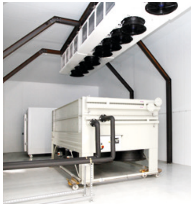
Оборудование, проходящее испытание в большой калориметрической камере
